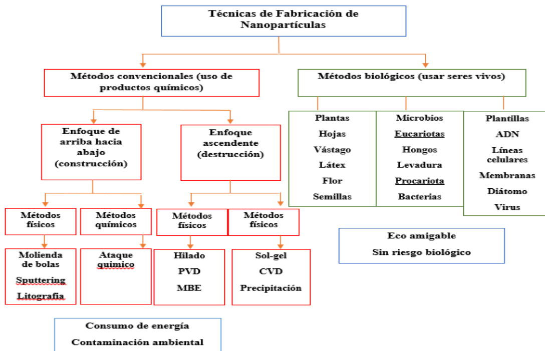
Figura 2. Clasificación de diferentes métodos de síntesis nanopartículas (Shamailay col., 2016).
